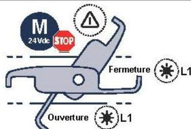
Vérifier que la manœuvre s'arrête à la butée de fin de course (L1 allumé). Sinon, modifier le seuil de courant en suivant la procédure au §2.4 (page 7) et recommencer.
