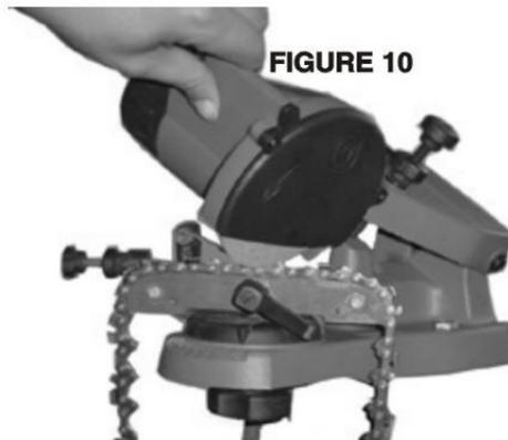
**2** Après contrôle de la conformité de vos réglages, procéder à l'affûtage. Pour un affûtage optimum, éviter de vous arrêtez trop de temps sur la même dent, allez y de façon graduel.
