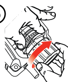
Крепко удерживайте патрон и затяните сверло кольцом так, чтобы оно больше не двигалось. Устройство готово к заточке
