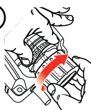
Κρατήστε σταθερό τον σφιγκτήρα (τσόκ) και ασφαλίστε/σφίξτε το τρυπάνι με την βοήθεια του δακτυλίου σύσφιξης/χαλάρωσης έως ότου σταθεροποιηθεί
