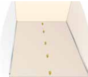
1 LISSES PLACÉES ET POSE DES APPUIS OPTIMA 2 15-45
