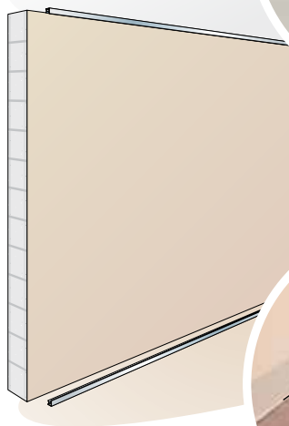
Lisses Clip'Optima basse et haute fixées au sol et au plafond.
