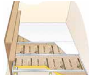
8 MONTAGE AVEC SOLIVES PARALLÈLES
