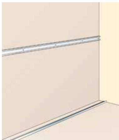
Figure 1 : pose des lisses Clip'Optima et de la fourrure murale Optima.
