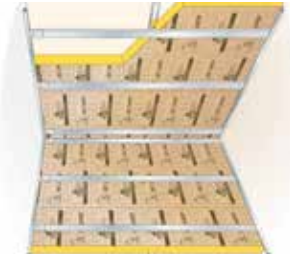
3 POSE DES FOURRURES VERTICALES
