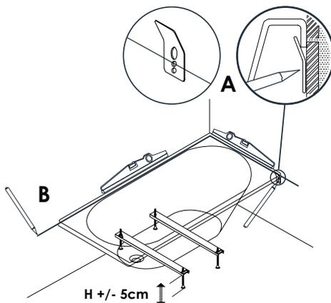
**⚠** Si vous souhaitez monter un tablier de baignoire (habillage vendu séparément), le bas du contour de la baignoire doit être ajusté en fonction de la hauteur du tablier.
