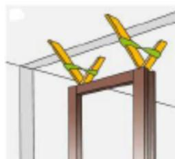
**MEDIUM ENROBE** : Certains des produits à composante médium sont conçus pour être mis en œuvre sur des cloisons et chapes sèches. En aucun cas les pieds de l'huisserie ne doivent être noyés dans la chape sans une protection maximale contre l'humidité.
