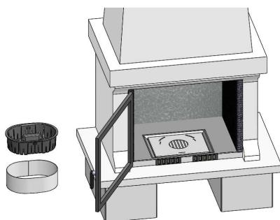
**2 -** Enlevez le pare- bûche si nécessaire, et posez la plaque d'embase (1) sur la sole de l'insert, au centre du foyer, rabats vers le bas, pour assurer la circulation de l'air. L'en-coche de positionnement de la chemise doit se situer du côté de la porte de l'insert.
