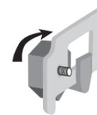
régler le niveau vertical en tournant les silent blocs avec vis
