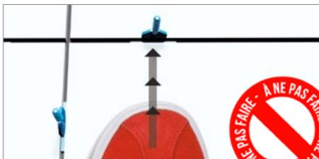
\* Un serrage trop intensif du cadran risque une rupture prématurée du croisillon.
