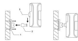
Le détecteur doit être installé à 2 mètres du sol
