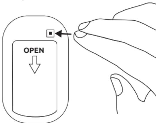
Un signal d'appairage est envoyé au système d'alarme : le détecteur est appairé après confirmation de la centrale (2 bips sur les centrales **SECURIZY**, **SECURIZY+** et **SECURIZY Home** et «Ajouté avec succès» entendu sur la centrale **SECURIZY Home 4G**).
