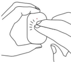
Prenez le détecteur en main puis créez un choc, une vibration en tapotant sur la face de celui-ci avec vos doigts. Le voyant du détecteur s'allume en rouge. Un signal d'appariage est envoyé au système d'alarme
