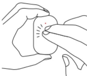
Prenez le détecteur en main puis créez un choc, une vibration en tapotant sur la face de celui-ci avec vos doigts. Le voyant du détecteur s'allume en rouge. Un signal d'appairage est envoyé au système d'alarme
