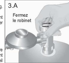
Dans des conditions normales d'utilisation et afin de garantir le bon fonctionnement de l'installation, nous recommandons le remplacement du dispositif régulateur dans les 10 ans suivant la date de fabrication. Ce délai de 10 ans ne constitue qu'une recommandation à laquelle des réglementations nationales ou un code de bonnes pratiques peuvent se substituer.
