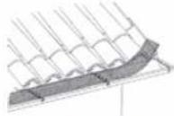
3. Découper le filet pour l'adapter à la taille de votre gouttière et le placer sur les clips en l'enfonçant sur les ergots.
