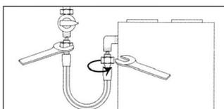
4. Visser à la main l'écrou du flexible, côté robinet, après avoir vérifié que le joint est dans son siège et en bon état.
