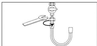
6. Visser à la main l'écrou inox côté appareil, après avoir vérifié que le joint est dans son siège et en bon état.
