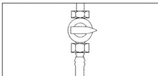
1. Fermer le robinet de commande avant de démonter les têtes.
