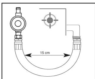
3. Ouvrir le robinet de gaz. Vérifier l'étanchéité en appliquant de l'eau savonneuse : aucune bulle ne doit apparaître.
