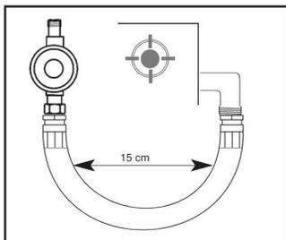
3. Ouvrir le robinet de gaz. Vérifier l'étanchéité en appliquant de l'eau savonneuse : aucune bulle ne doit apparaître.
