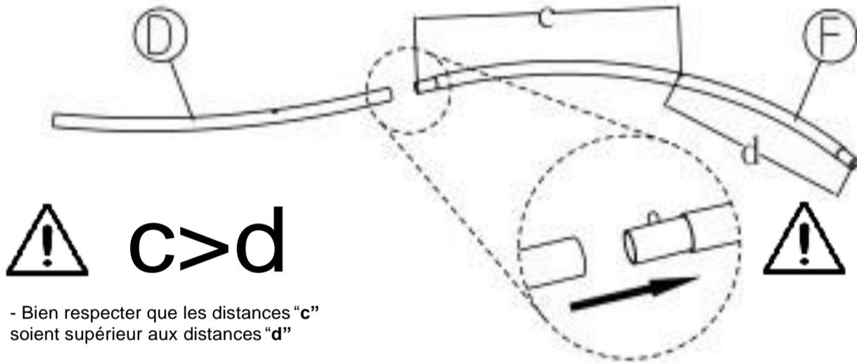
MONTAGE DES TUBES POUR TOILE D'ASSISE EN TEXTYLENE DU DESSOUS
