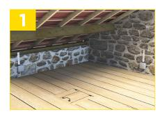
Fixer les boitiers électriques en hauteur (minimum 10 cm du plancher) et indiquez leurs emplacements avec les piges graduées prévue à cet effet dans le kit de mise en œuvre.
