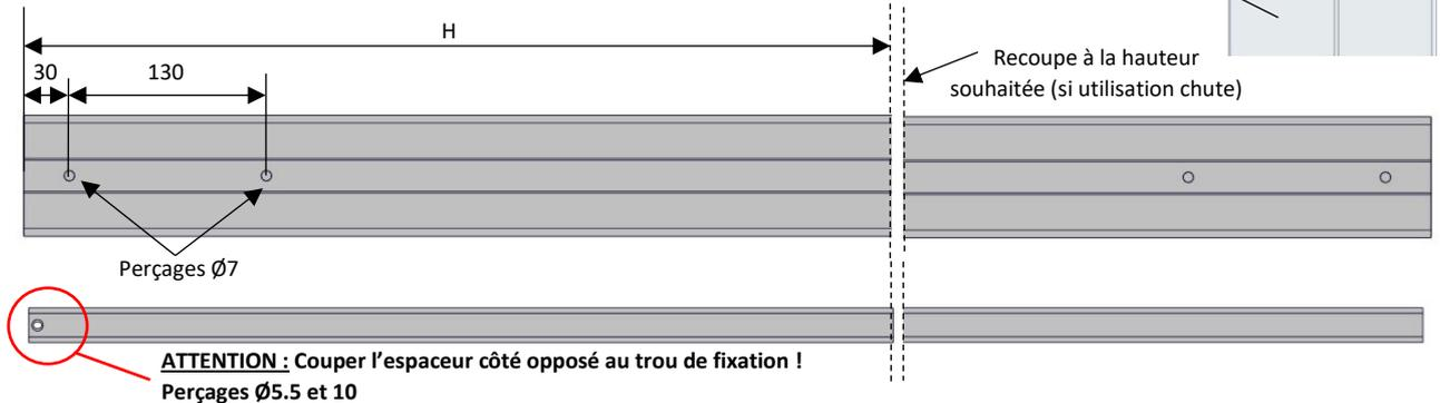
**Remarque générale :** Il est vivement conseillé de procéder à une pose « à l'avancée » (Poser 2 poteaux avec le 1<sup>er</sup> remplissage ; puis, poteau suivant avec 2<sup>nd</sup> remplissage, etc..)
