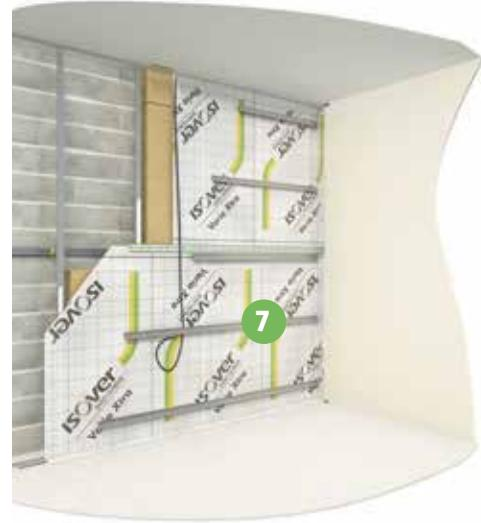
**7** Lorsqu'un espace technique est nécessaire, il convient de réaliser une ossature spécifique rapportée à l'aide de profilés métalliques
