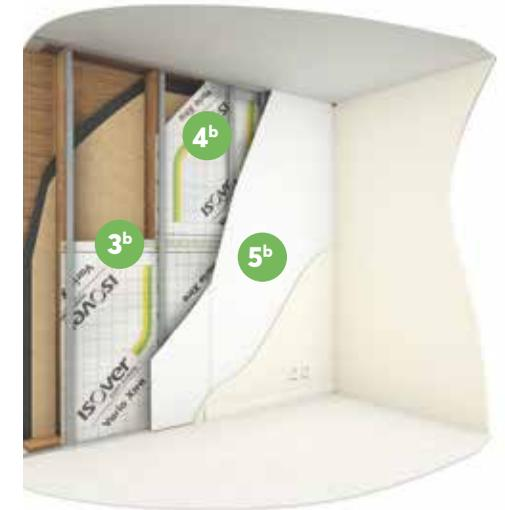
**3<sup>b</sup>** Fixation des appuis Optima<sub>2</sub> 15-45 tous les 600 mm directement sur les montants bois
