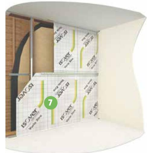
**7** Pose de la membrane Vario® Xtra sur les fourrures à l'aide d'un adhésif double face. Recouvrement de 10 cm des lés de membrane dans toutes les directions, avec l'adhésif Vario® Multitape ou Vario® KB1. La jonction membrane/maçonnerie est assurée avec le mastic Vario® Double Fit. Une pose perpendiculaire au sens des montants est privilégiée. Dans le cas contraire, le recouvrement des lés doit être réalisé au droit des montants (**CPT 3728**)
