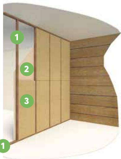
**1** Pose des montants bois, **conformément aux DTU 31.2 et 25.41**
