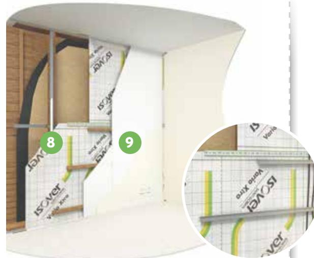
**8** Lorsqu'un espace technique est nécessaire, il convient de réaliser une ossature spécifique rapportée à l'aide de profilés métalliques ou bois
