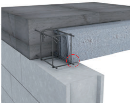
Pour les dalles alvéolées : l'appui minimal sur mur en maçonnerie est de 7,5 cm
