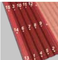
15 fixations minimums doivent être utilisées par plaque. Attendez de fixer la dernière onde avant de recouvrir celle-ci par la plaque suivante.
