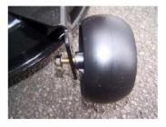
Le plateau : montage des roues anti-scalping arrière et avant (selon modèles). En aucun cas, elles ne supportent la coupe au travail, les régler selon la hauteur de coupe souhaitée
