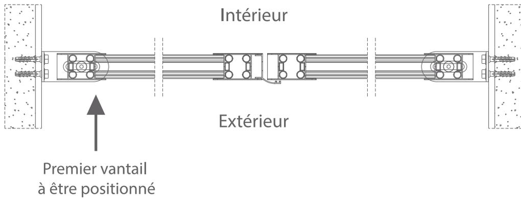
**1** Repérage des crapaudines: Positionner le gabarit de perçage contre le bord du pilier intérieur. Plier selon les gros pointillés, l'angle ainsi obtenu en bas du pilier à hauteur du sol, vous permettra de pointer les trous de fixation de la crapaudine que vous allez devoir installer
