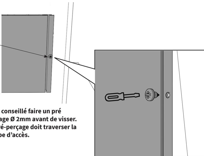
Il est conseillé faire un pré perçage  $\varnothing$  2mm avant de visser. Le pré-perçage doit traverser la trappe d'accès.
