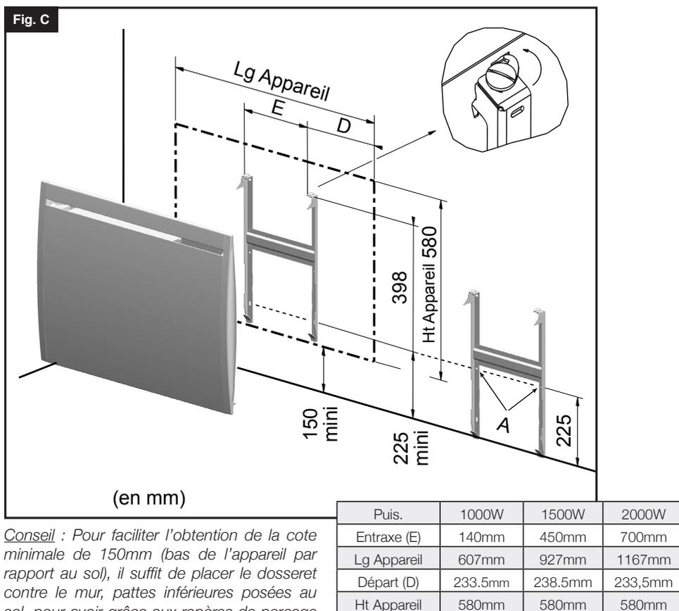
*Conseil* : Pour faciliter l'obtention de la cote minimale de 150mm (bas de l'appareil par rapport au sol), il suffit de placer le dossier contre le mur, pattes inférieures posées au sol, pour avoir grâce aux repères de perçage (Rep. A Fig. C), les deux fixations inférieures du dossier.
