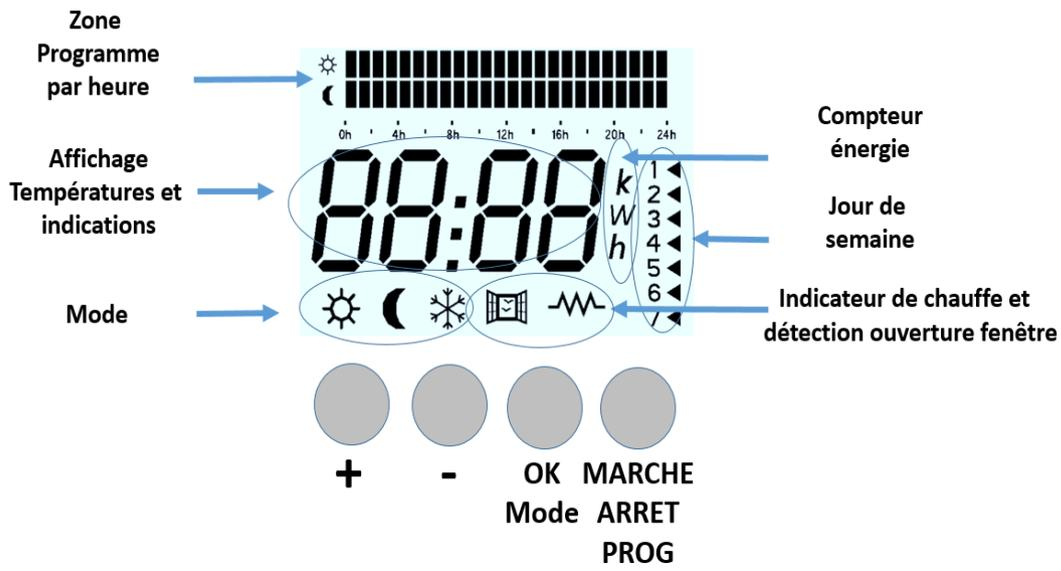
**Rappel :** votre appareil est équipé d'un interrupteur situé à l'arrière droit de votre appareil. En l'activant, les résistances sont mises sous tension, l'écran reste en fonction et votre programmation est conservée.
