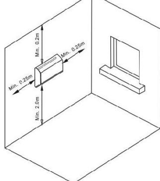
Taladre los orificios de fijación, coloque los tacos y los tornillos (atención: utilice tacos adecuados en función de su tipo de pared). Cuelgue el aparato de los tornillos respetando el orden de los
