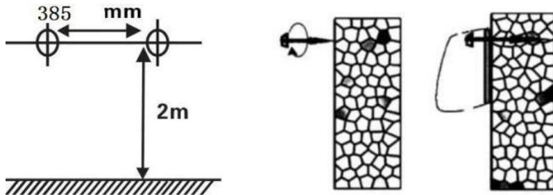
Mueva el aparato ligeramente hacia la derecha todo lo que pueda. 3) Deje que el aparato descance sobre los tornillos moviéndolo hacia abajo. Asegúrese de que el aparato esté firmemente sujetada antes de soltarla.
