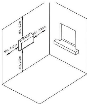
Percer les trous de fixation, placer les chevilles et les vis (attention, utiliser les chevilles adéquates en fonction de votre type de mur). Suspendre l'appareil aux vis en respectant l'ordre
