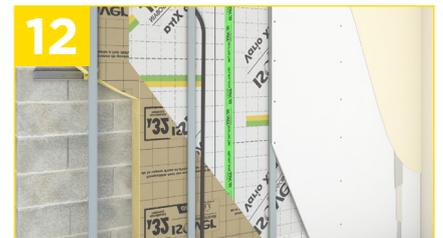
Coupez les plaques de plâtre à la hauteur sol-plafond moins 1 cm. Vissez les plaques de plâtre tous les 30 cm sur les fourrures avec des vis TTPC 25. Réalisez le joint entre les plaques de plâtre à l'aide de bandes et d'enduit.
