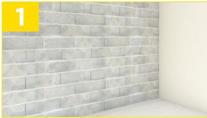
Tracez (au bleu) l'emplacement des lisses Clip'Optima au sol et au plafond en tenant compte de l'épaisseur de l'isolant + de la plaque de plâtre. Dans le cas où vous isolez un mur avec fenêtre, tenez compte de la tapée\* de celle-ci.
