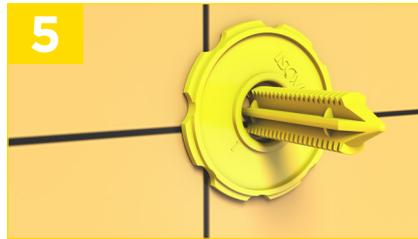
Mettez en place les rondelles rigides (jaunes) des pastilles Optima, en laissant dépasser l'appui de 3 à 4 cm. Bloquez la rondelle par une rotation d'un quart de tour.
