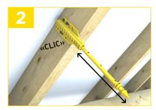
Réglez la longueur de tige de la suspente selon l'épaisseur d'isolant souhaitée puis verrouillez la tige entre 20 et 30 cm.
