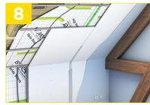
Vissez les plaques de plâtre tous les 30 cm sur les fourrures Optima 240 (plaques perpendiculaires aux fourrures) avec des vis TTPC 25.
