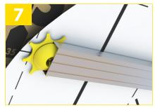
Clipsez les fourrures métalliques Optima 240 sur les clés de suspentes.
