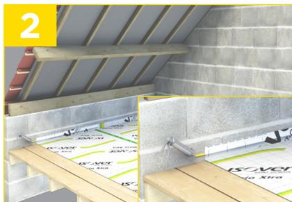
Pour assurer l'étanchéité à l'air, jointoyez les lés avec l'adhésif Vario® de votre choix puis collez au mur avec le mastic, les 10 cm de la membrane laissée sur toute la périphérie du comble.
