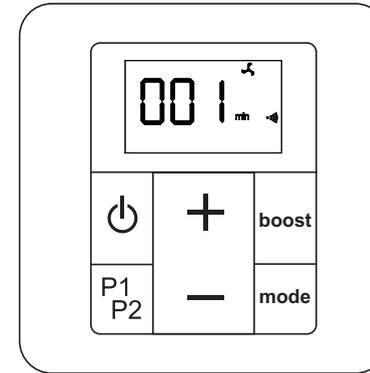
La durée prévue pour le boost est terminée. L'appareil revient à son fonctionnement normal.
