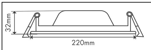
Il est toujours recommandé de percer un trou un peu plus petit que la taille indiquée puis de limer le trou jusqu'à l'encastrement du produit.
