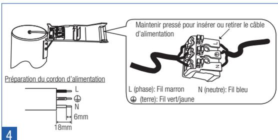
Raccordement électrique des spots en parallèle:
