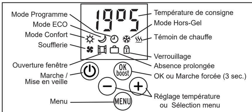
*L'icône et la valeur en cours de réglage clignotent. Le clignotement s'arrête quand le réglage est validé par la touche **OK-boost**, ou après 30 secondes d'inaction (la modification du réglage est alors annulée).*
