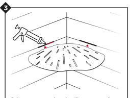
Déposer un cordon de silicone ou colle colle PU dans les creux. Insérer la tablette.
