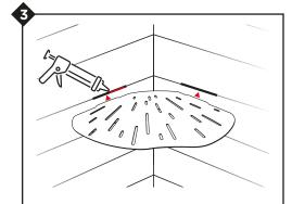
Déposer un cordon de silicone ou colle colle PU dans les creux. Insérer la tablette.
