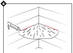
Déposer un cordon de silicone au-dessus et en-dessous de la tablette de douche. Respecter le temps de séchage du silicone avant utilisation.
