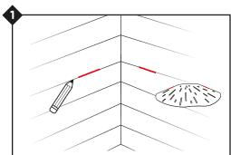
Sur le joint de carrelage choisi pour l'installation de la tablette MI Shelf, marquer les emplacements où le joint doit être creusé pour accueillir les ailettes de fixation.
