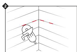
Creuser le joint avec un outil adapté (meuleuse d'angle, outil multifonctions...) sur 3 à 4 mm de profondeur.
