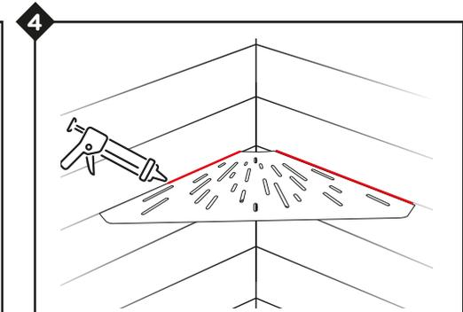
Déposer un cordon de silicone au-dessus et en-dessous de la tablette de douche. Respecter le temps de séchage du silicone avant utilisation.
