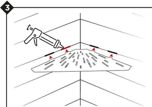
Déposer un cordon de silicone ou colle colle PU dans les creux.
