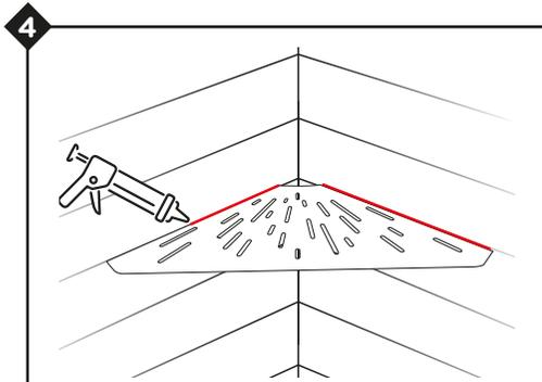
Déposer un cordon de silicone au-dessus et en-dessous de la tablette de douche. Respecter le temps de séchage du silicone avant utilisation.
