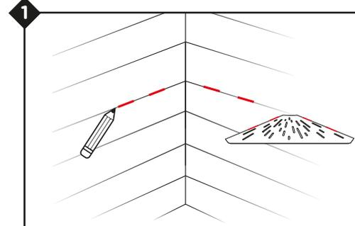
Sur le joint de carrelage choisi pour l'installation de la tablette MI Shelf, marquer les emplacements où le joint doit être creusé pour accueillir les ailettes de fixation.
