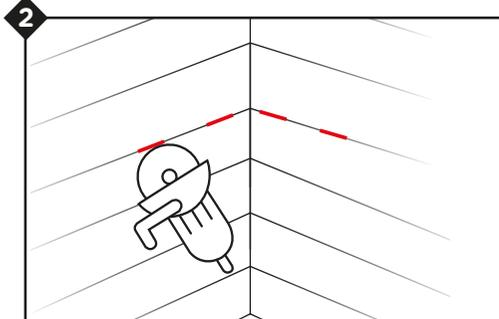
Creuser le joint avec un outil adapté (meuleuse d'angle, outil multifonctions...) sur 3 à 4 mm de profondeur.
