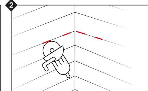
Creuser le joint avec un outil adapté (meuleuse d'angle, outil multifonctions...) sur 3 à 4 mm de profondeur.
