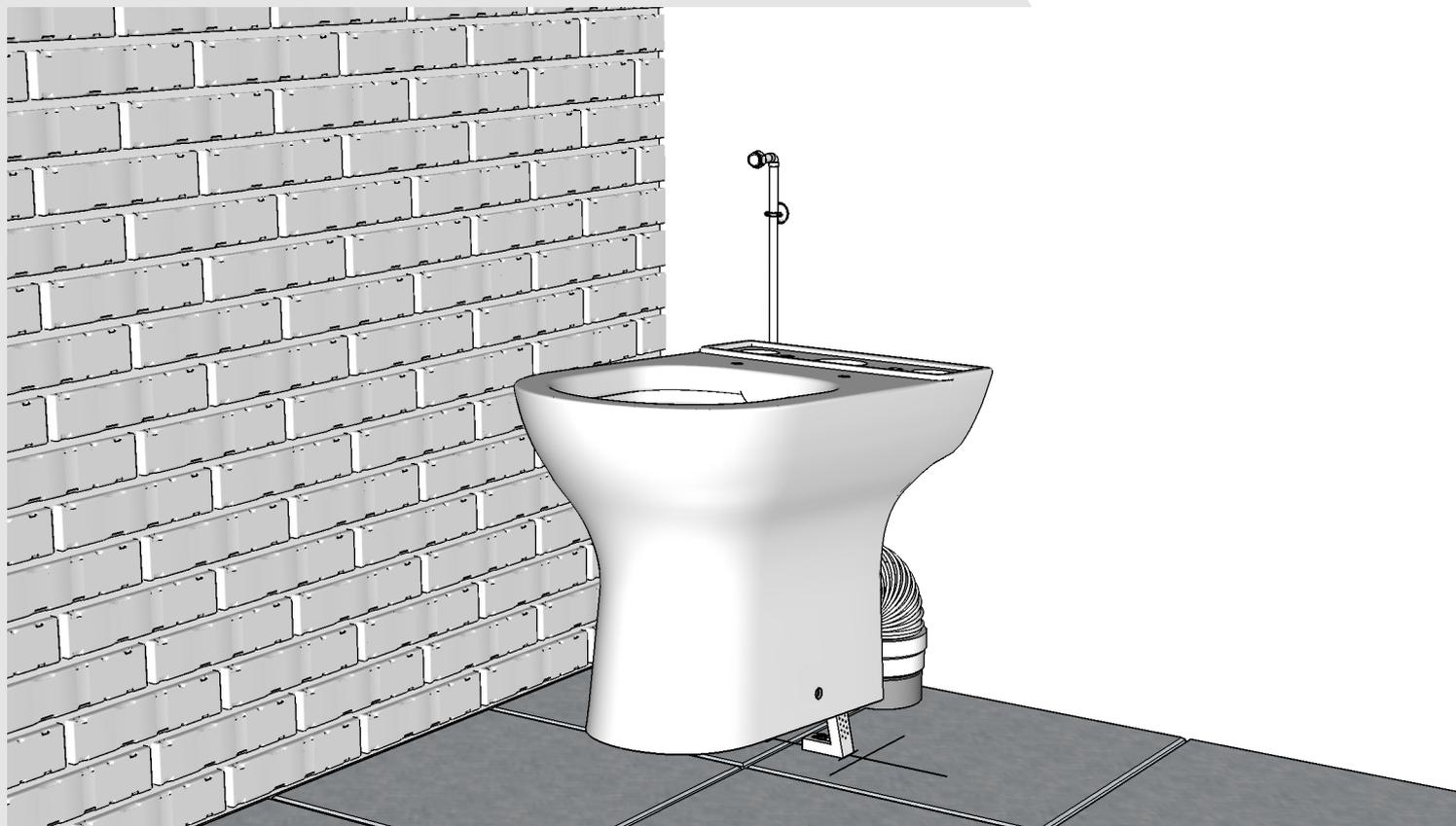
Finaliser le serrage de la cuvette par les cotés, ne pas oublier de mettre les bagues isolantes (1) et monter les caches (2) en dernier.
