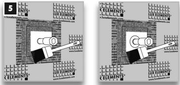
**( DE ) Schritt 5 –** Der Anschluss an Rohrdurchdringungen (1/2 Zoll) erfolgt über die Wandmanschette LUX ELEMENTS®-DRY-DBWM oder LUX ELEMENTS®-DRY-DBDZM, die stramm über die Rohrdurchdringung gezogen wird. Die angrenzende Dichtbahn LUX ELEMENTS®-DRY-DF ist dicht an die Durchdringung heranzuführen und hohlräumfrei an die Wandmanschette wie unter Schritt 2 beschrieben anzuschließen (Überlappung mindestens 50 mm).
