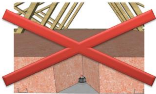
Figure 2 – Spot non protégé au contact de l'isolant interdit
