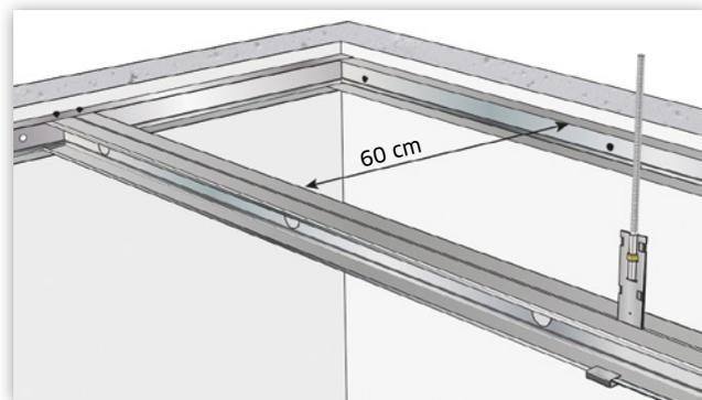
**Attention :** dans le cas de montage avec montants simples, afin d'éviter le basculement des montants, des lignes d'entretoise sont réalisées à l'aide de rails Stil® R 48 (ou fourrure Stil® F 530) fixés à mi-portée des appuis sur les ailes supérieures des montants.
