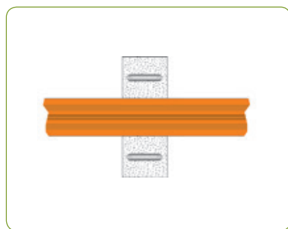
Raidisseurs accolés béton
