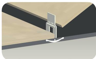
**1** Glisser le CLIPS blanc sous le bord du carreau à niveler. Puis poser le second carreau en butée contre le CLIPS, ou contre les croisillons d'écartement dans le cas d'un joint plus large.
