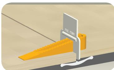
**2** Glisser une cale réutilisable jaune dans le CLIPS et l'enfoncer jusqu'à ce que les carreaux soient de même niveau.
