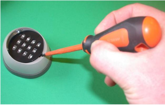
2/ Oter les 2 vis 6 pans pour retirer le socle arrière
