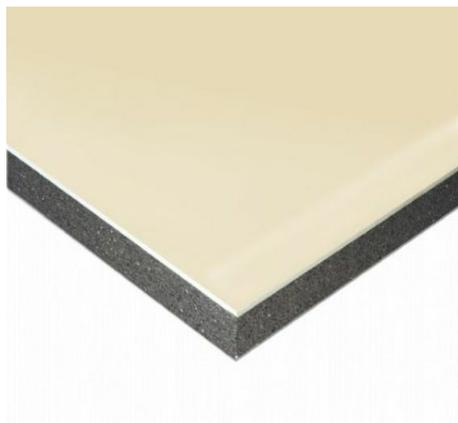
Complexe de doublage constitué d'un panneau isolant en polystyrène expansé (PSE) graphité, associé à une plaque de plâtre Placo®. Parement plaque de 13 mm permettant utilisation en ERP. Ancien libellé: Placomur® Ultra 32 13+80.
