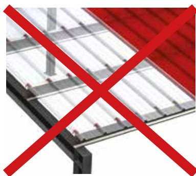
Interdit en rive
