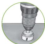
1. Réaliser le trou d'encastrement : Ø 60mm
