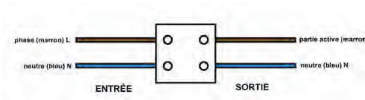
Cet appareil de classe II – IP44 peut être installé dans les volumes 2 ou 3 d'une salle de bain, conformément aux exigences de la norme française d'installation électrique NF C 15-100 (Voir schéma ci-dessous). Il ne peut en aucun cas être installé au-dessus d'une baignoire ou dans le volume du bac de douche.
