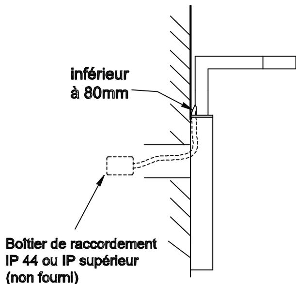
Connectez les conducteurs d'alimentation sur les bornes situées dans le boîtier (cf. schéma ci-dessous) Avant le raccordement des fils, vérifiez que le réseau électrique a été déconnecté. Ce luminaire est un appareil de **classe II**, il n'est pas nécessaire de le connecter à la terre.
