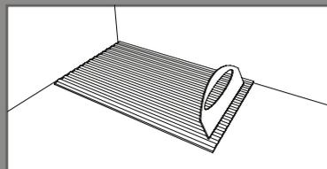
Appliquer la colle à carrelage sur le support à l'aide d'une spatule crantée (4mm)
