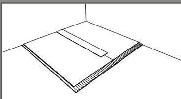
Placer les lés bord à bord et faire la jonction à l'aide de la bande d'étanchéité, préalablement encollée, avec une colle polymère
