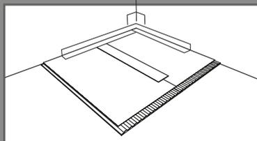
Dans le cadre d'une pose en pièce humide (salle de bains), appliquer la bande d'étanchéité et les angles à la jonction entre les murs et la natte.
